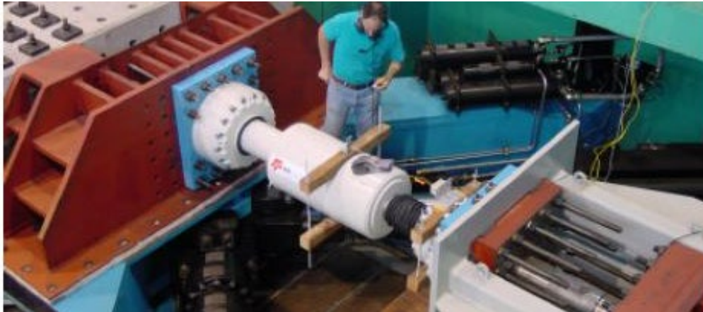
Figura 17 - Dissipador a ser testado em laboratório [22]
